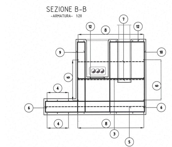
**DETTAGLIO UBICAZIONE POZZETTO NEI TRATTI IN RILEVATO**
