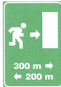
USCITE ALL'APERTO FIG. 7 CIRC. ANAS 7735 DEL 09/09/1999 - N.1 segnale dim. 60x100 cm
