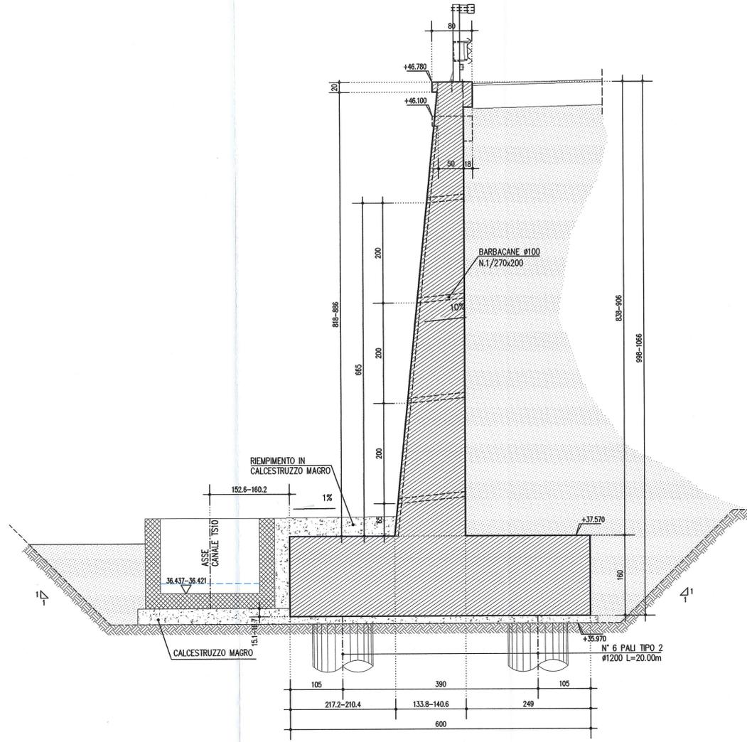
DETTAGLIO TESTA MURO 1:20
