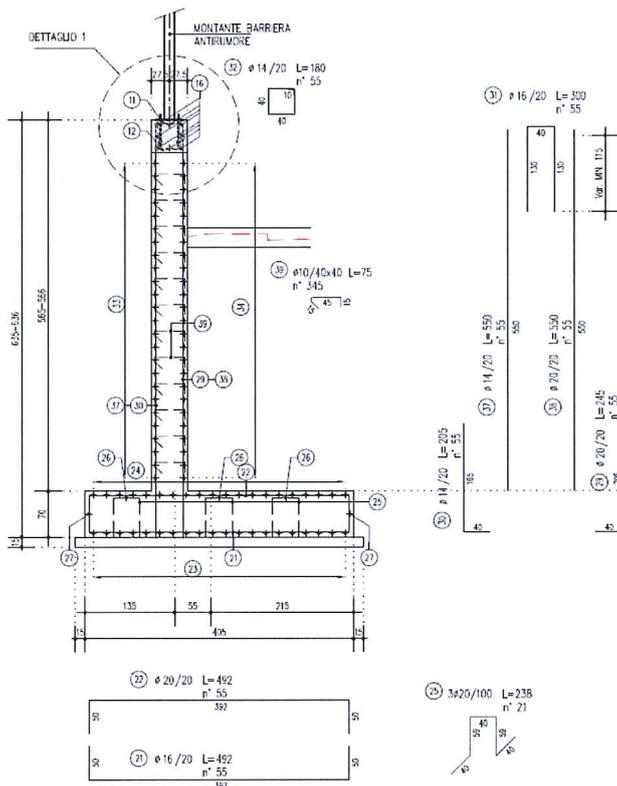
Figura 16-5 – Schema armatura – Muro tipo 4 –Concio 23
