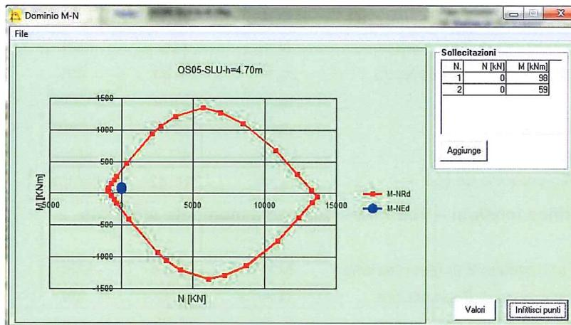
Figura 14-16 – Involuppo sollecitazioni SLU-STATICA/SISMICA – Sezione a momento massimo
