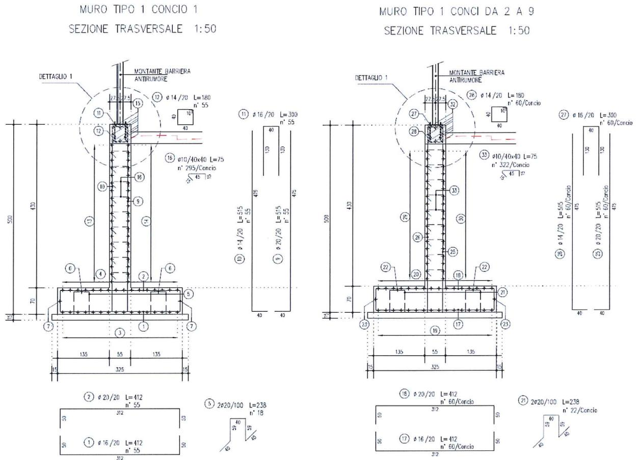
Figura 16-1 – Schema armatura – Muro tipo 1 –Conci 1-9
