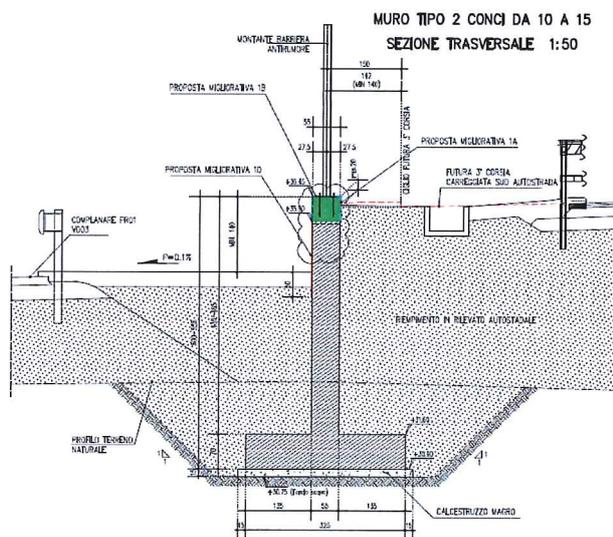
**Figura 1-3 – Sezione Tipo – Muro tipo 2 –Conci 10-15**
