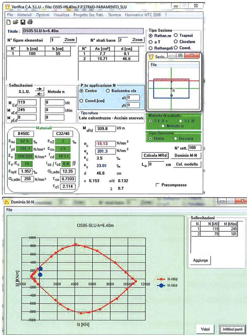
Figura 14-1 – Verifica Pressoflessione - SLU-STATICA/SISMICA - Sezione base muro
