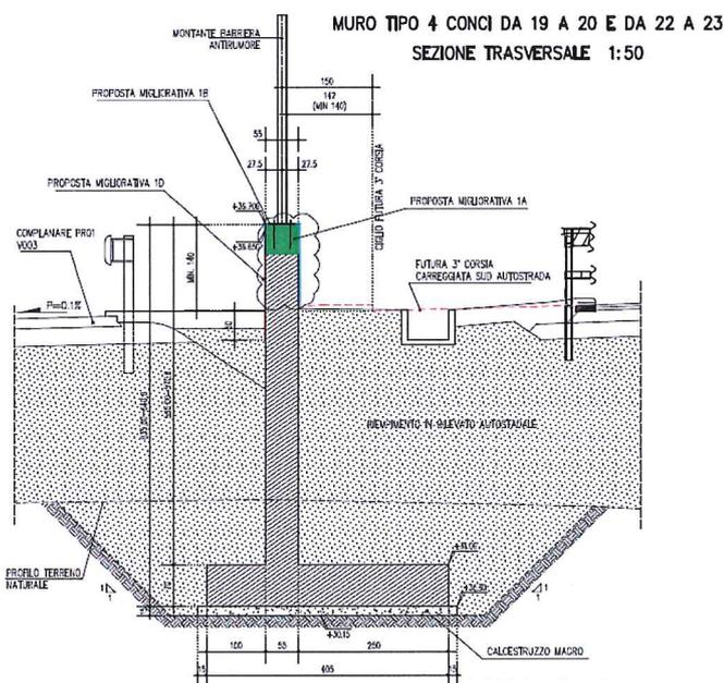
**Figura 1-5 – Sezione Tipo – Muro tipo 4 –Conci 19-20 e 22-23**
