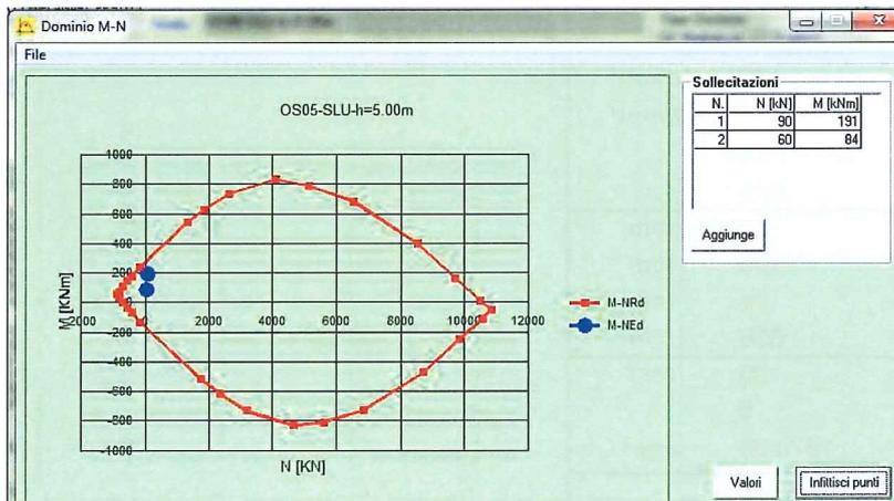
Figura 14-11 – Verifica Pressoflessione - SLU-STATICA/SISMICA - Sezione base muro
