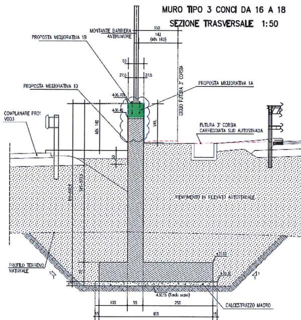
**Figura 1-4 – Sezione Tipo – Muro tipo 3 –Conci 16-18**
