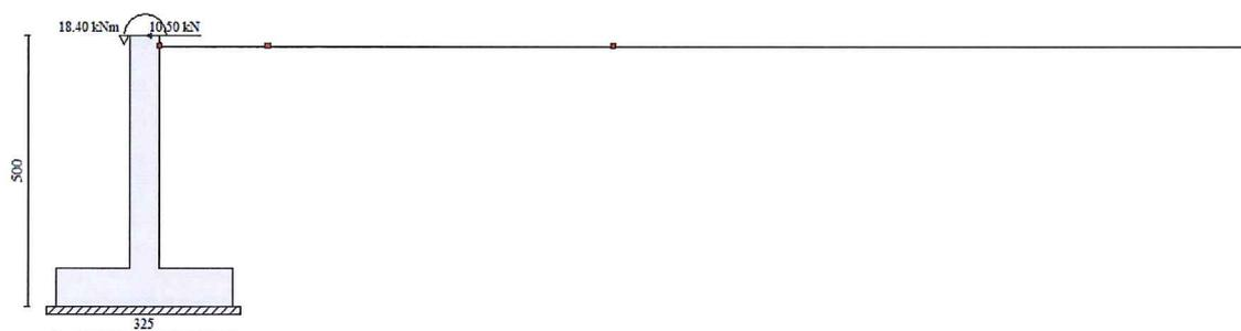
L'azione del vento è stata calcolata per un'altezza di barriera pari a 3.5m e considerando un interasse tra i montanti pari a 3m. Si ottiene:
