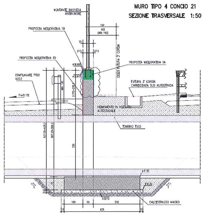
**Figura 1-6 – Sezione Tipo – Muro tipo 4 –Concio 21**
