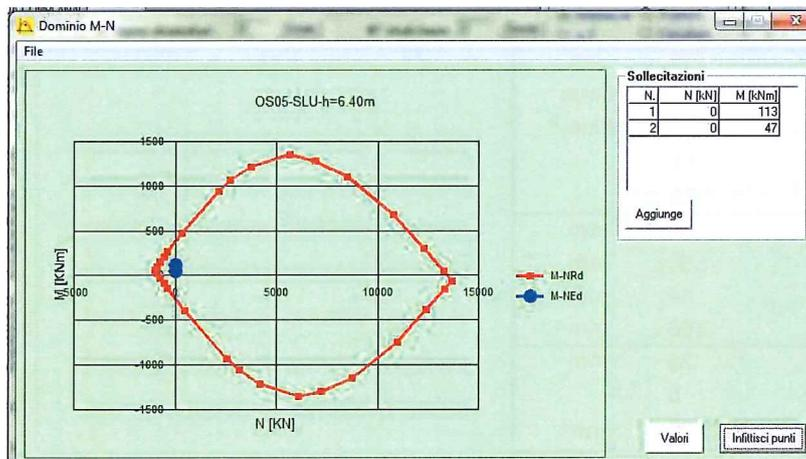
Figura 14-6 – Involuppo sollecitazioni SLU-STATICA/SISMICA – Sezione a momento massimo
