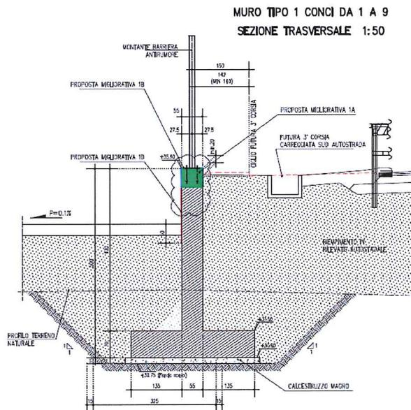
**Figura 1-2 – Sezione Tipo – Muro tipo 1 –Conci 1-9**
