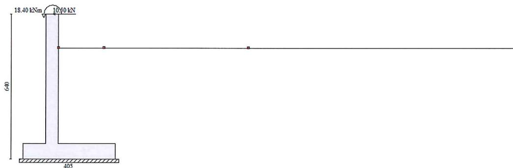
L'azione del vento è stata calcolata per un'altezza di barriera pari a 3.5m e considerando un interasse tra i montanti pari a 3m. Si ottiene:
