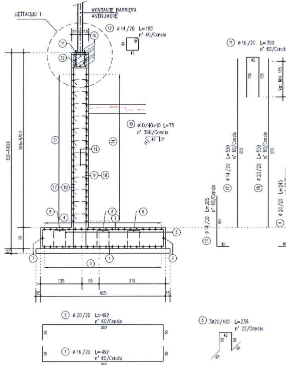
Figura 16-4 – Schema armatura – Muro tipo 4 –Conci 19-20-22
