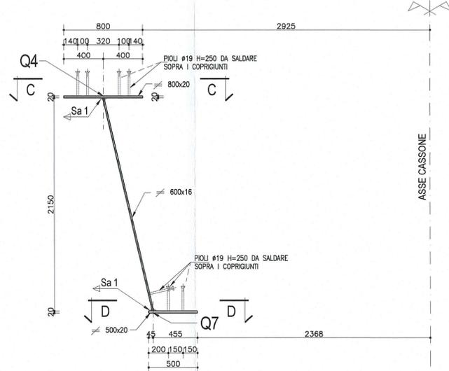
1/2 SEZIONE A-A - PARTICOLARE GIUNTO TRAVI METALLICHE
