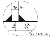
1/2 SEZIONE D-D PIATTABANDA INFERIORE DX
