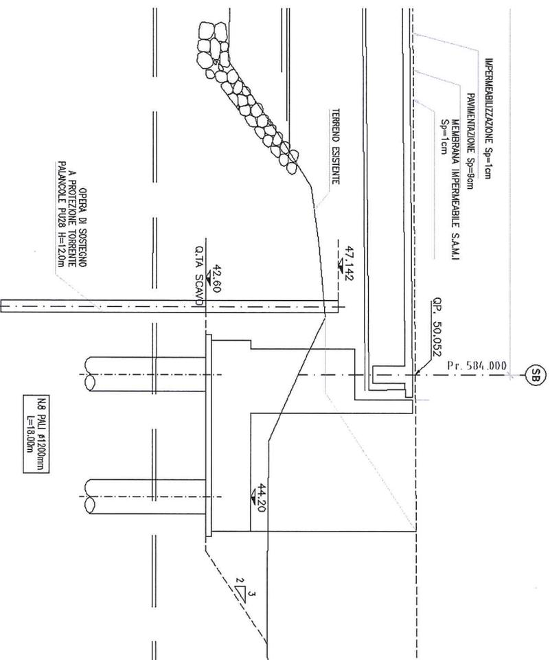
FIGURA 1 – SEZIONE LONGITUDINALE PALANCOLE SPALLA B
