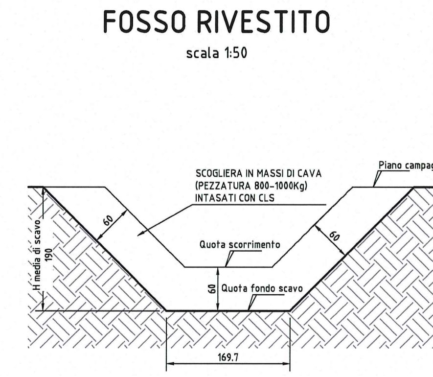
SEZIONE TIPO DI SCAVO FOSSO RIVESTITO scala 1:50
