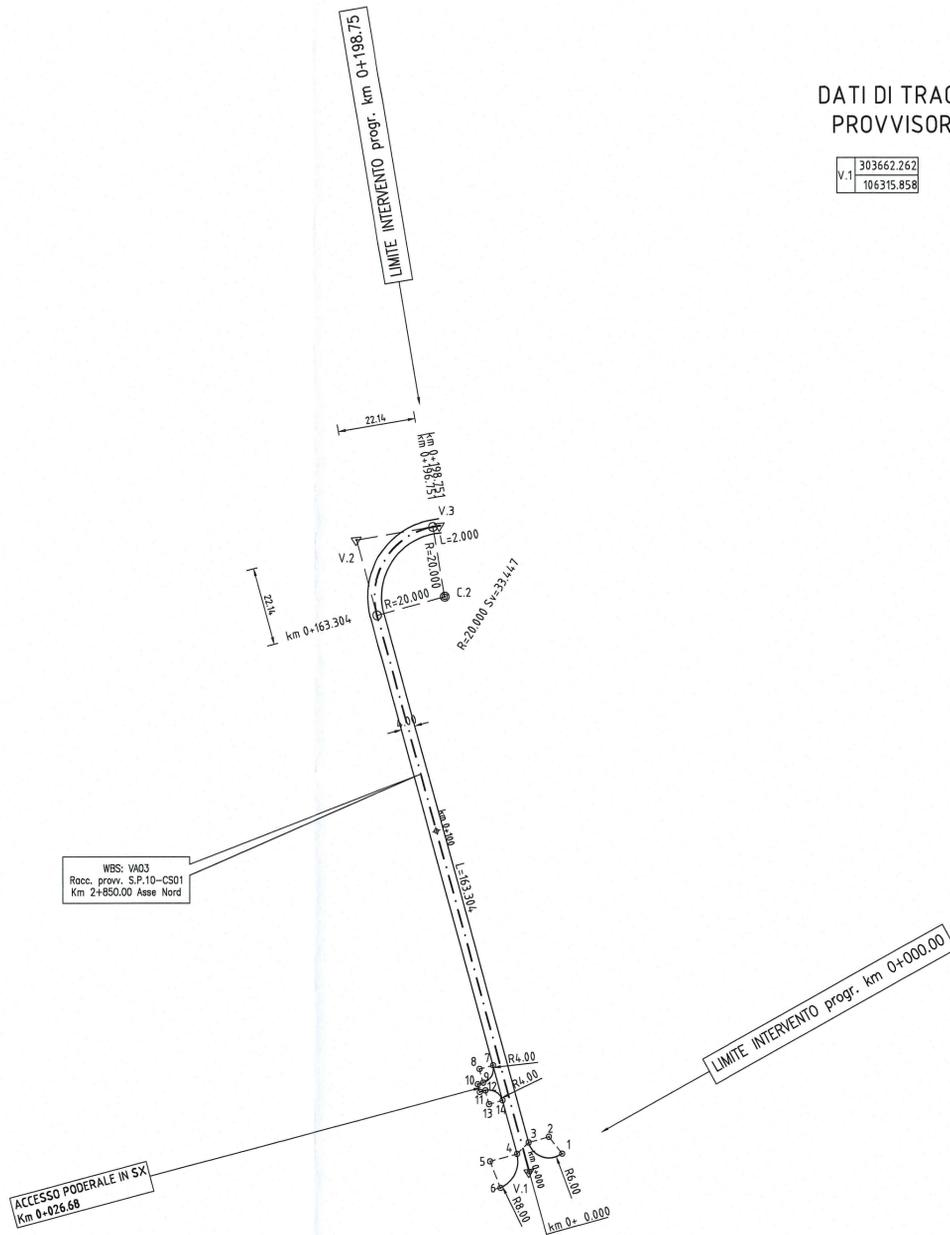
**DATI DI TRACCIAMENTO RACCORDO PROVVISORIO TRA S.P.10 E CS01**
