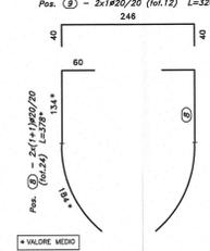
DETTAGLIO ARMATURA VALIDO SOLO PER LE PILE P1/2
