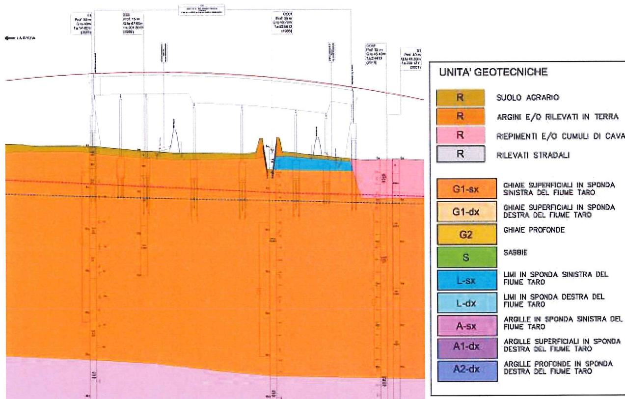
Fig. 6.2 Profilo Geotecnico
