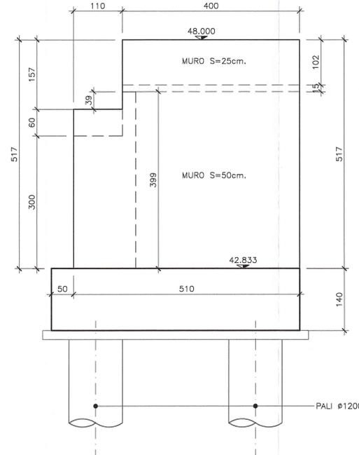
MURETTO DI RACCORDO DUNA IDRAULICA
