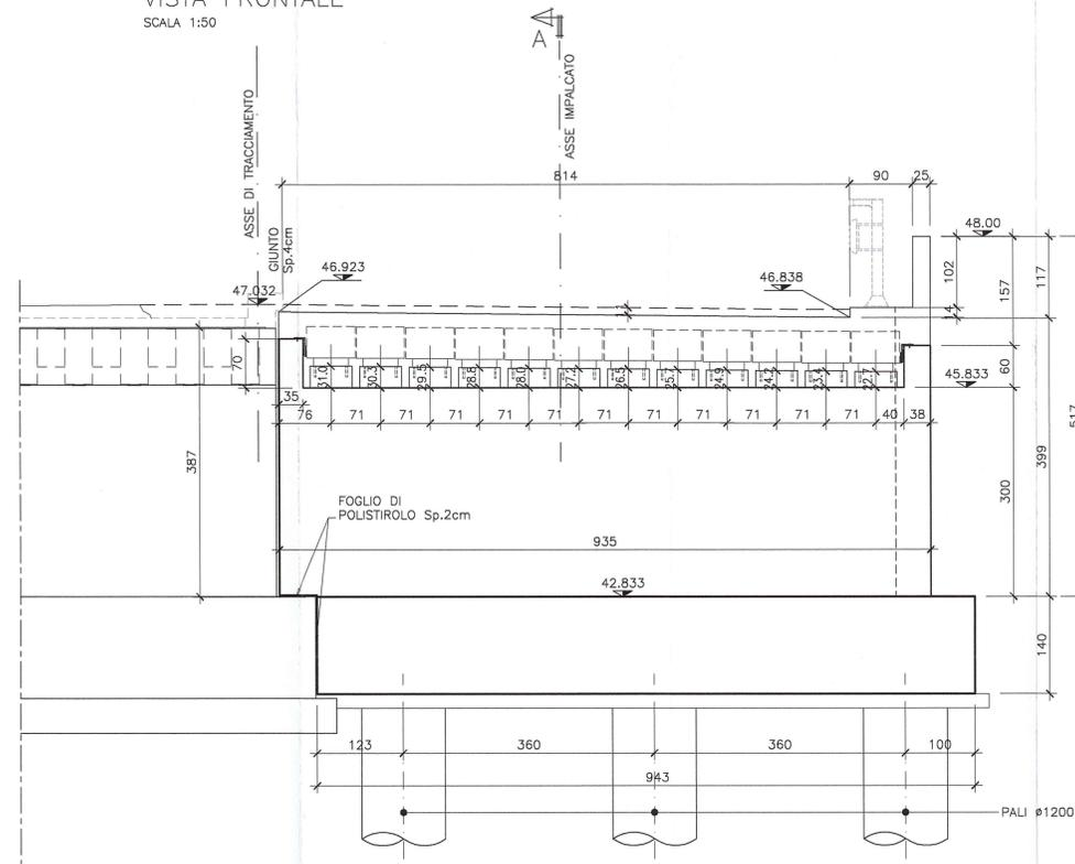
MURETTO DI RACCORDO DUNA IDRAULICA - SPALLA B
