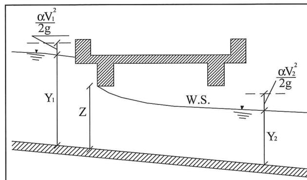
Fig. 5 – Sezione schematica di un ponte – Schema di calcolo
