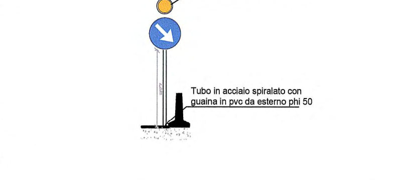
PARTICOLARE IMPIANTO SEGNALETICO PROFILO RIDIRETTIVO
