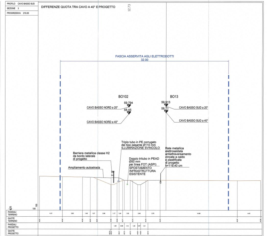
DOPPIO TRITUBO IN PEAD Ø50 PER LINEA FOT (ASPI) - SPOSTAMENTO INFRASTRUTTURA ESISTENTE -
