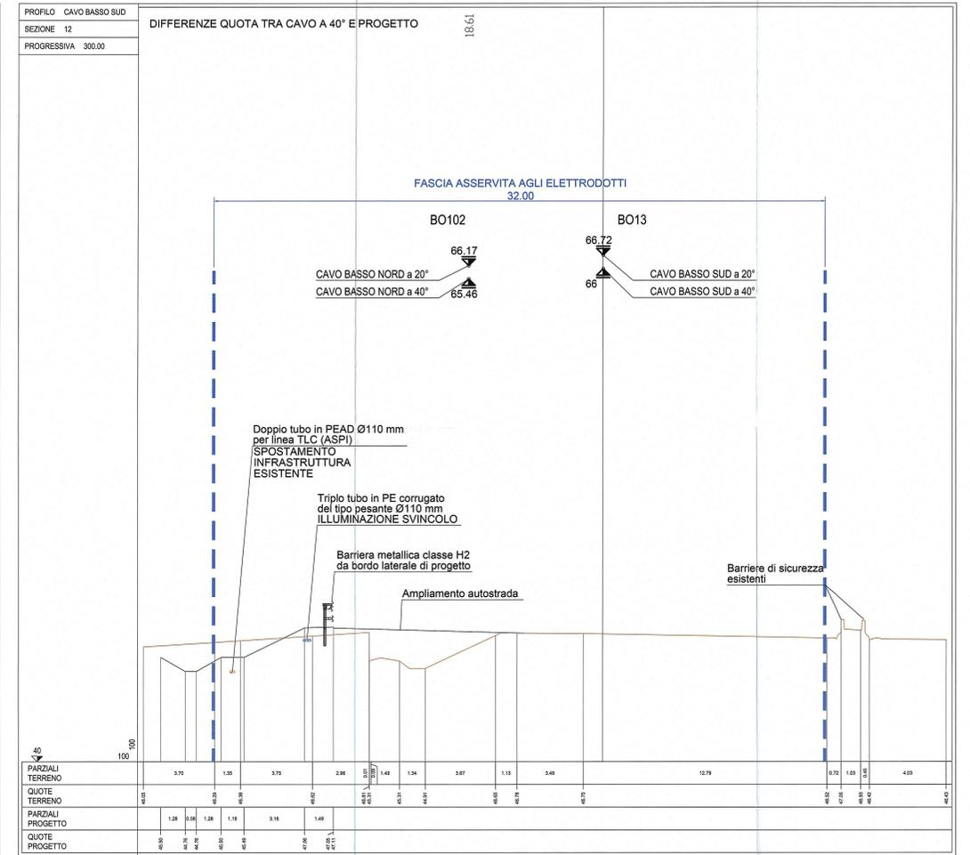
TRIPLO TUBO IN PE CORRUGATO DEL TIPO PESANTE Ø110 mm - ILLUMINAZIONE SVINCOLO LATO NORD -
