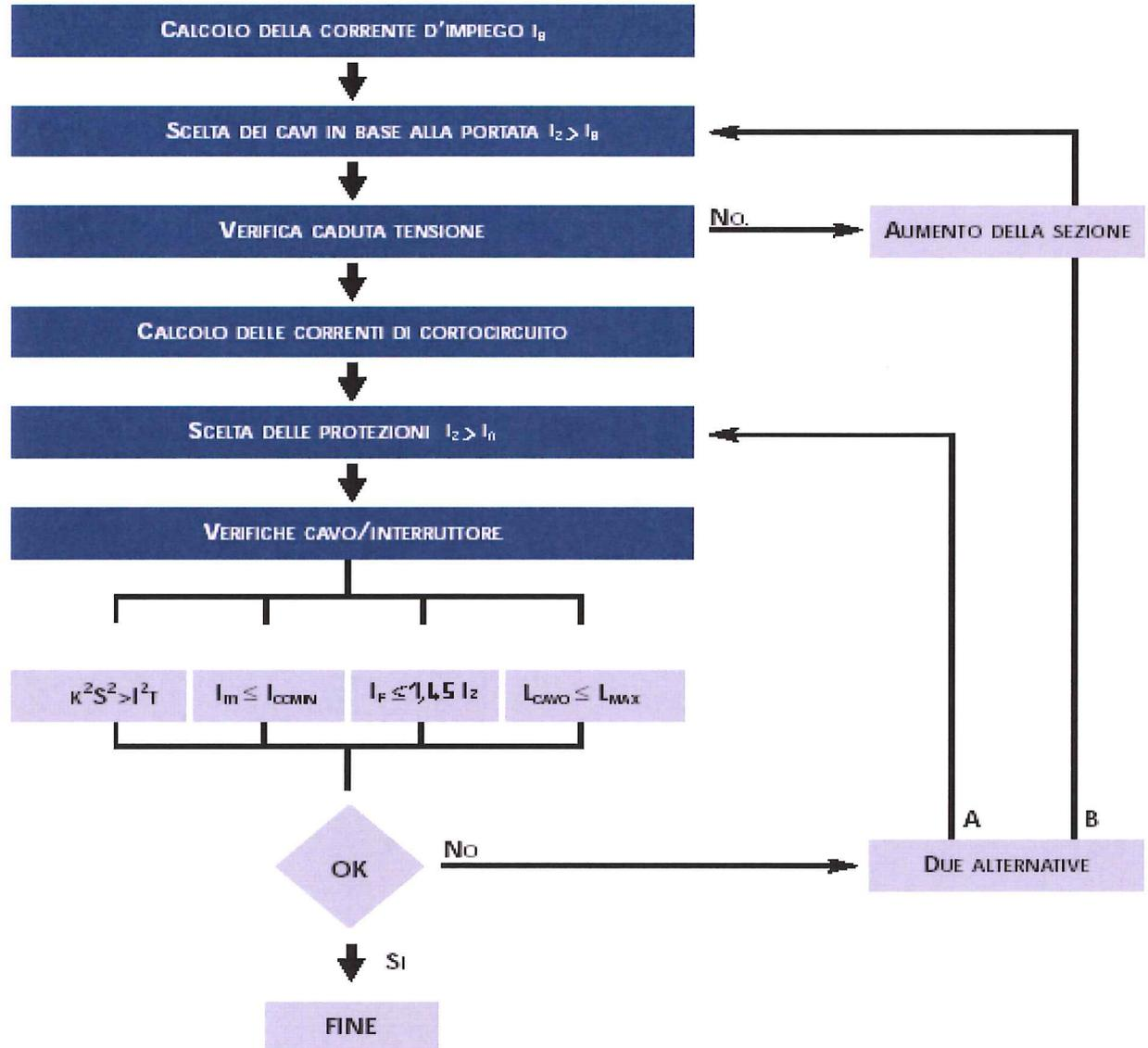
Nota : La Verifica  $I_f \leq 1,45 I_z$  non è stata effettuata nel caso si siano utilizzati interruttori automatici per la protezione dei cavi in quanto le caratteristiche costruttive degli interruttori stessi garantiscono che la  $I_f =$  Corrente di sicuro funzionamento sia inferiore a 1,45 di  $I_n$ , pertanto considerato che  $I_n \leq I_z$  la disequazione precedentemente citata è sempre verificata.
