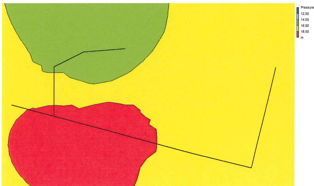
*Pressioni caratteristiche 1B con 1 irrigatore in esercizio e massimo consumo diurno – ore 13-*
