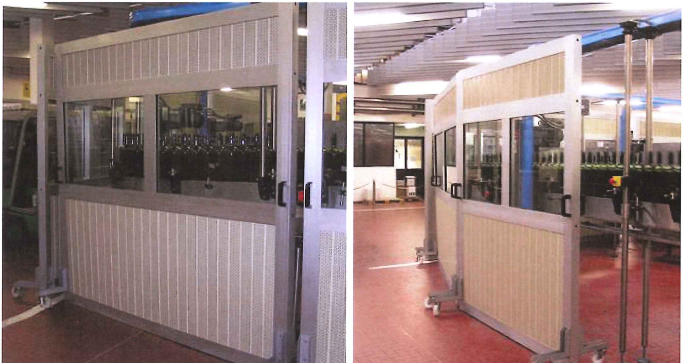
Figura 9 Esempi di barriere mobili per impianto
