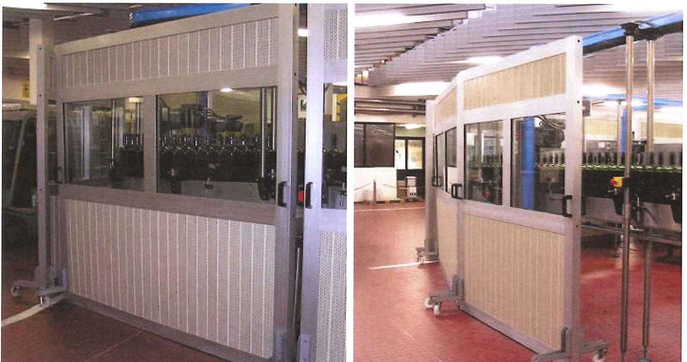
Figura 8 Esempi di barriere mobili per impianto
