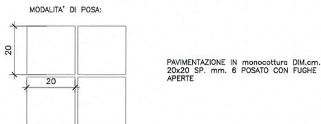
PAVIMENTAZIONE IN monocottura DIM.cm. 20x20 SP. mm. 6 POSATO CON FUGHE APERTE
