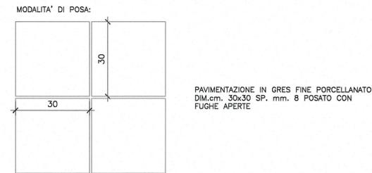
PAVIMENTAZIONE IN GRES FINE PORCELLANATO DIM.cm. 30x30 SP. mm. 8 POSATO CON FUGHE APERTE
