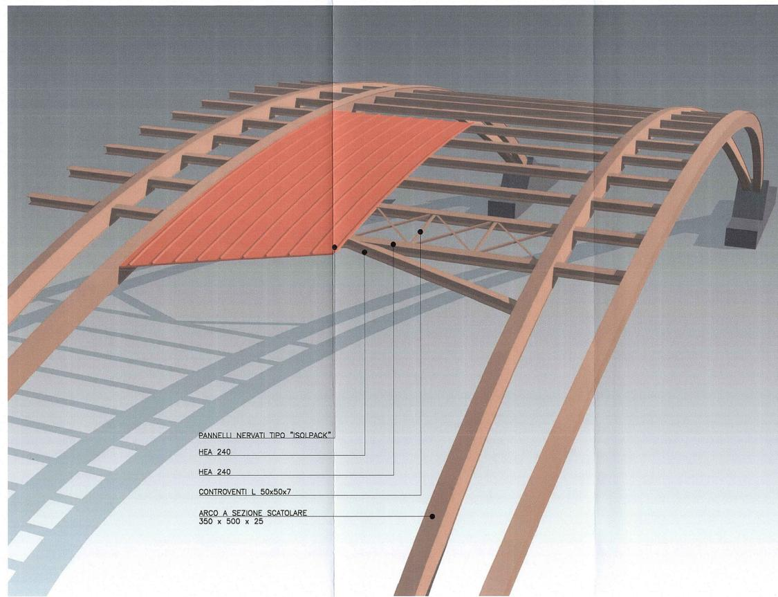
Struttura portante in acciaio + pannelli nervati (tipo isolpack)
