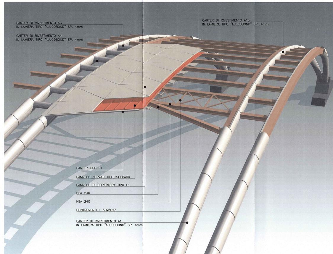
Rivestimento arcate con carter in lamiera (tipo Alucobond) - Copertura in pannelli triangolari di lamiera
