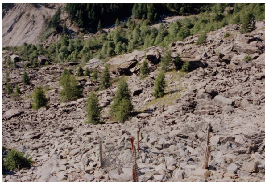
Figura D-8 – Zona alta della ex cava B. Si notano le pezzature minori in primo piano (massi per muretti a secco) e le pezzature ciclopiche a distanza
