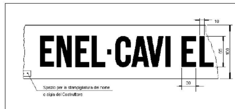
Figura 8 – Nastro di segnalazione
