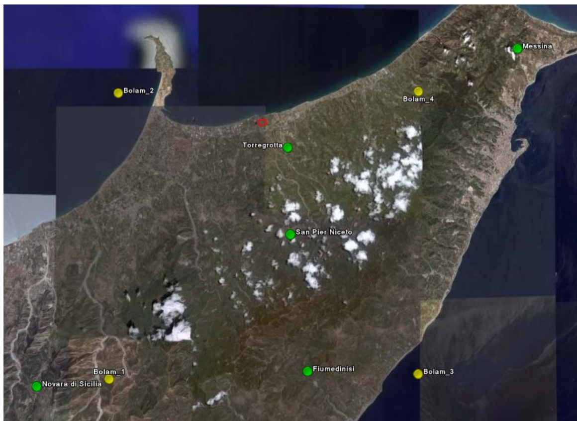
Figura 3.3.5-A. Posizione delle stazioni di misura SIAS al suolo (cerchi verdi) e dei profili verticali BOLAM21 (cerchi gialli) utilizzati per la ricostruzione del campo di vento con CALMET.
