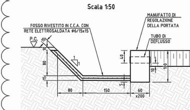
TESTATA DI IMBOCCO E SBOCCO
