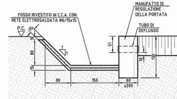
TESTATA DI IMBOCCO E SBocco
