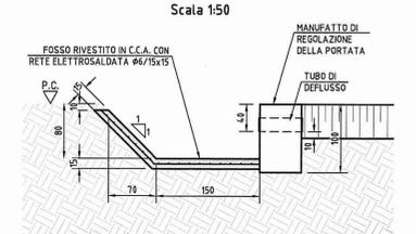
**TESTATA DI IMBOCCO E SBocco**
