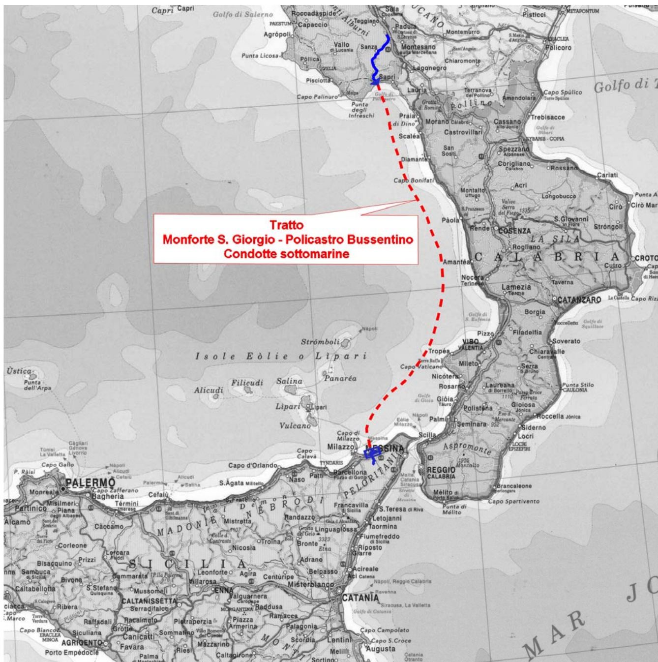
Quadro schematico del sistema "Iniziativa Sealine tirrenica" (in rosso: il tratto in oggetto)
