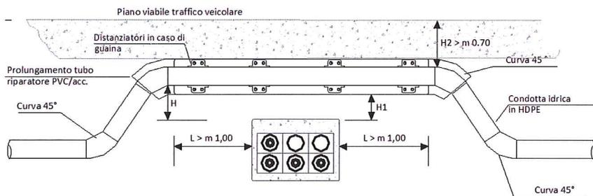
NOTE: Se  $H_2 < m\ 0.70$  eseguire getto in cls con rete elettrosaldata su tubo riparatore con prolungamento dello stesso; distanza minima senza protezione,  $m\ 0,50$  (H);
