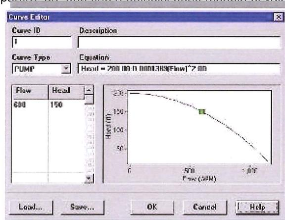
Esempio di curva di funzionamento di una pompa
