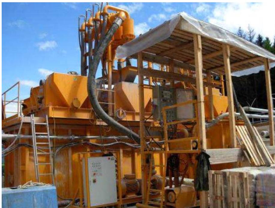
Fig. 7.1.10-E – Sistema di disidratazione
