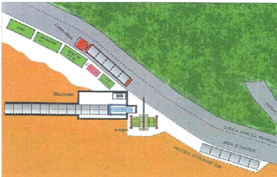
**Fig. 7.1.10-C** – Schema tipo di un cantiere per l'installazione di un microtunnel
