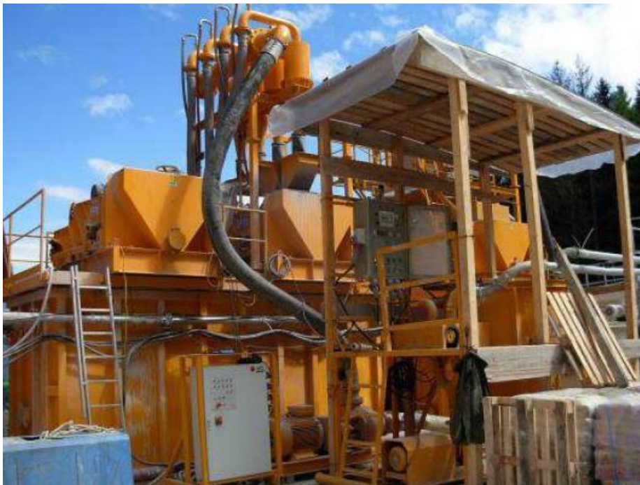
Fig. 8.1.10/E – Sistema di disidratazione
