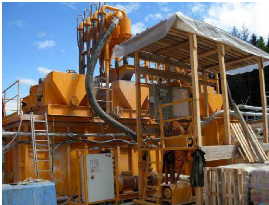
Fig. II 5.1.10/E – Sistema di disidratazione
