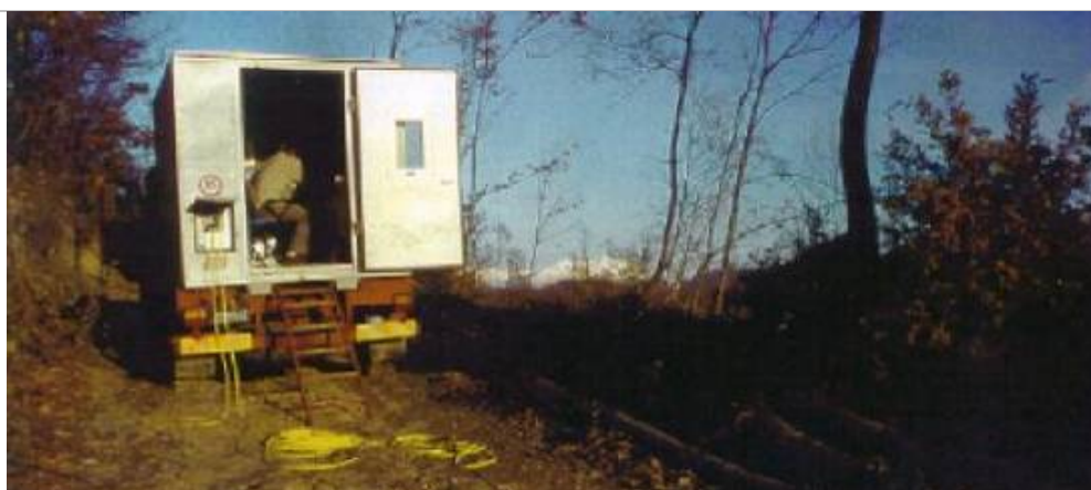
Figura 47: Stendimento di geofoni su strada e particolare di automezzo per acquisizione geofisica
