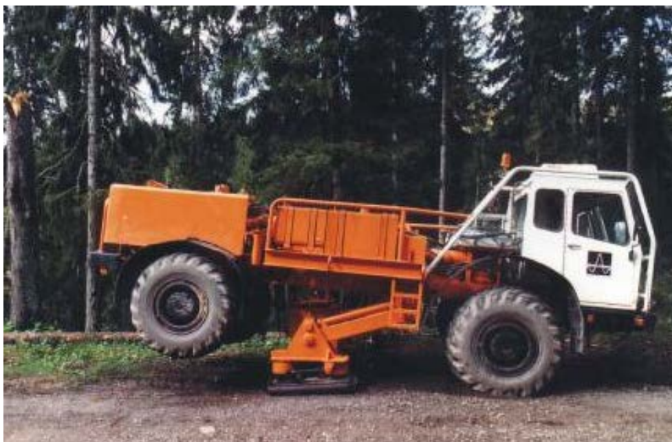
Figura 49: Esempio di campagna di indagine geofisica eseguita a mezzo vibratorii in ambito seminaturale
