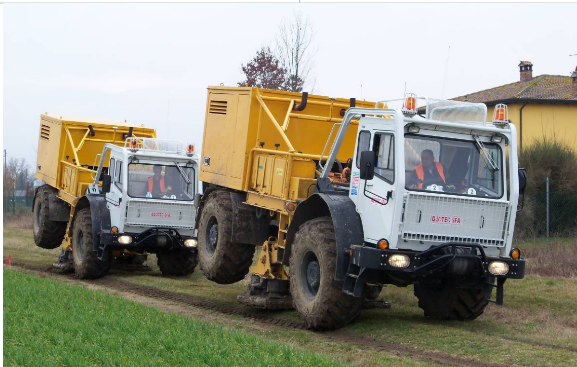
Figura 44: Esempio di mezzi vibroseis dotati di vibratore predisposto per l'energizzazione del terreno
