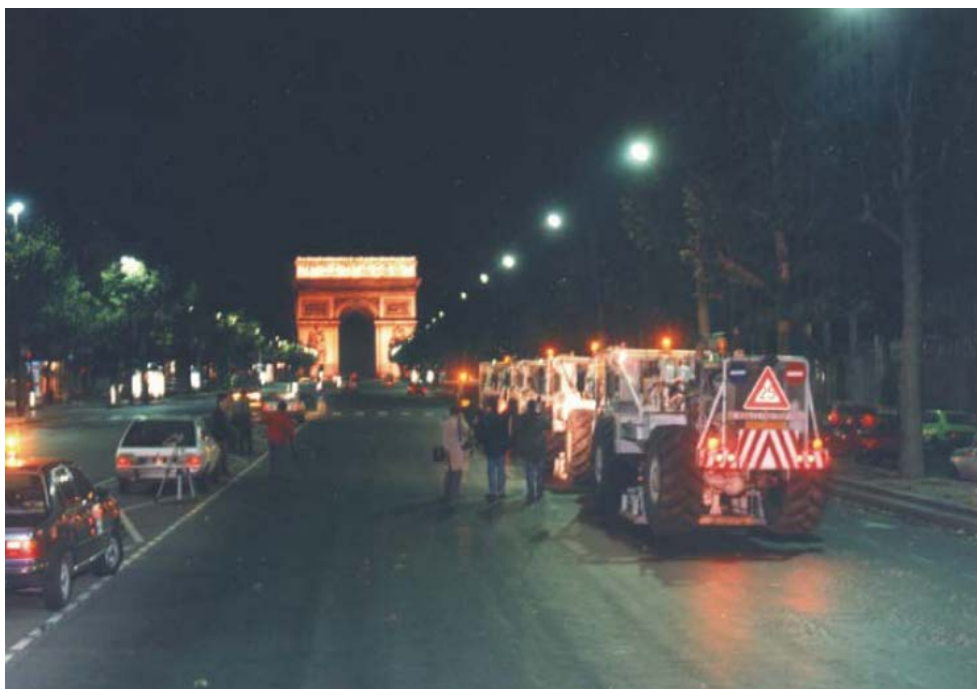
Figura 48: Esempio di campagna di indagine geofisica con vibratorii in ambito urbano (Parigi, 1988)
