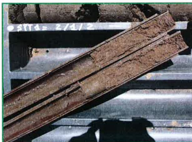
Figura 1: Dettaglio campione Raymond SPT_1
