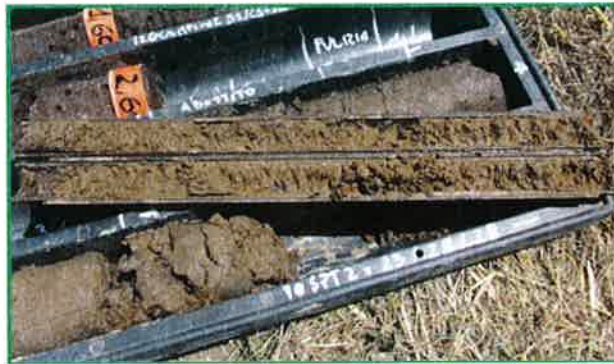
Figura 2: Dettaglio campione Raymond SPT_2
