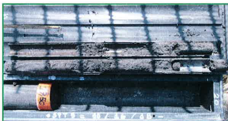
Figura 5: Dettaglio campione Raymond SPT_5
