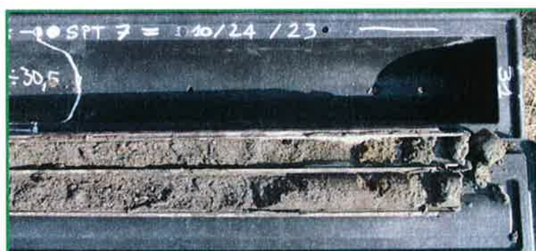
Figura 7: Dettaglio campione Raymond SPT_7
