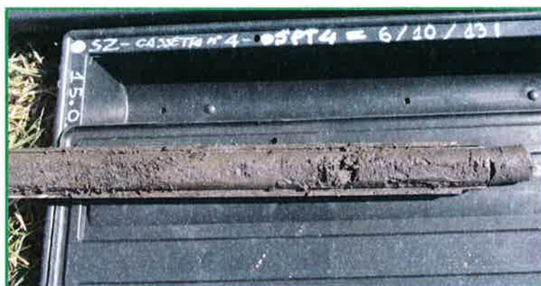
Figura 4: Dettaglio campione Raymond SPT_4
