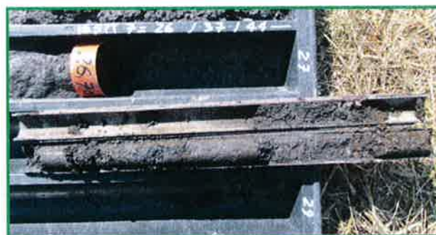
Figura 7: Dettaglio campione Raymond SPT_7
