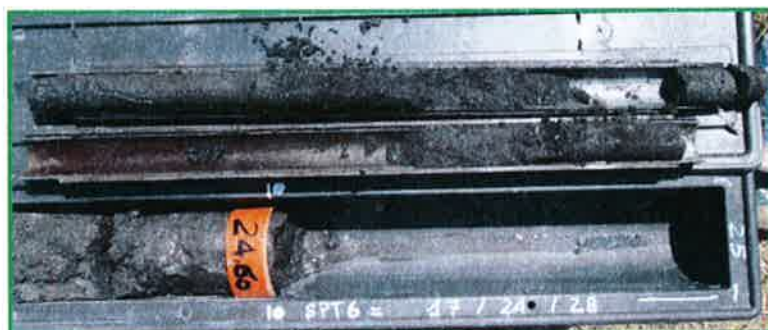
Figura 6: Dettaglio campione Raymond SPT_6
