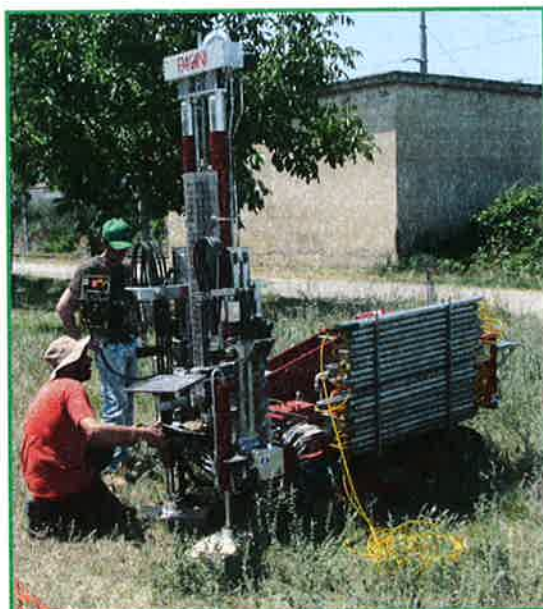
Figura 4: Penetrometro TG63-200 PAGANI con piezocono
