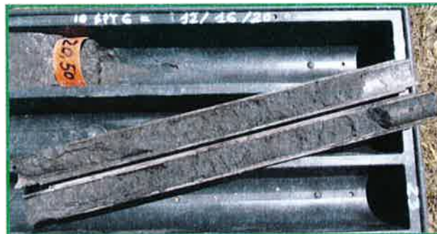
Figura 6: Dettaglio campione Raymond SPT_6
