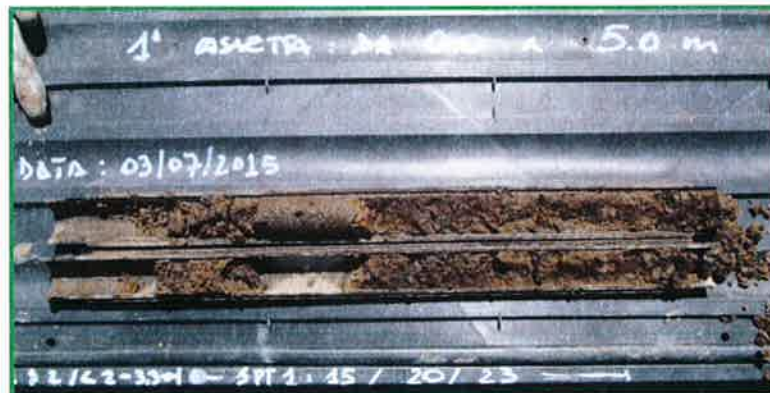
Figura 1: Dettaglio campione Raymond SPT_1
