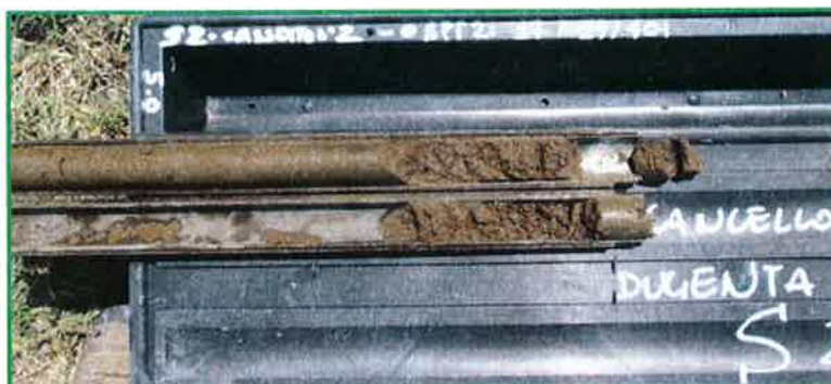
Figura 2: Dettaglio campione Raymond SPT_2
