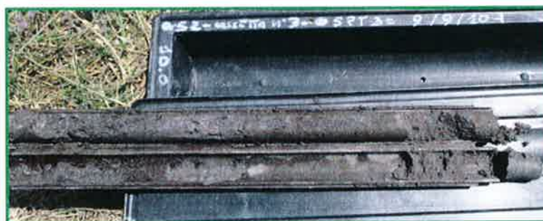
Figura 3: Dettaglio campione Raymond SPT_3
