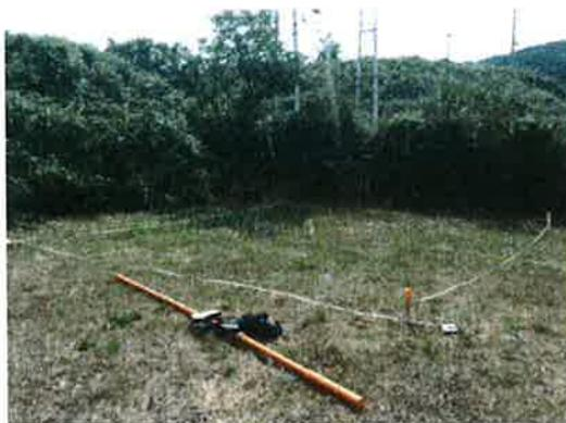
*Figura 3: Elettromagnetometro CMD*
