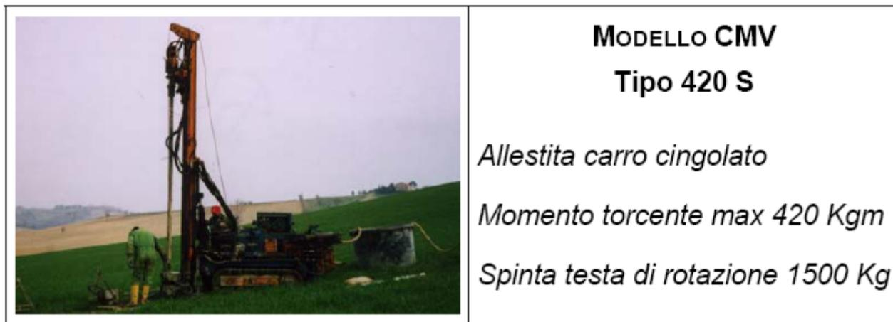
Il carotaggio continuo è stato effettuato, conformemente alla natura dei terreni attraversati, utilizzando un sistema di perforazione tradizionale costituito da batteria di aste e carotiere semplice da 101 mm di diametro. La stabilizzazione del foro è stata ottenuta previo rivestimento, mediante tubazioni da 127 mm di diametro.
