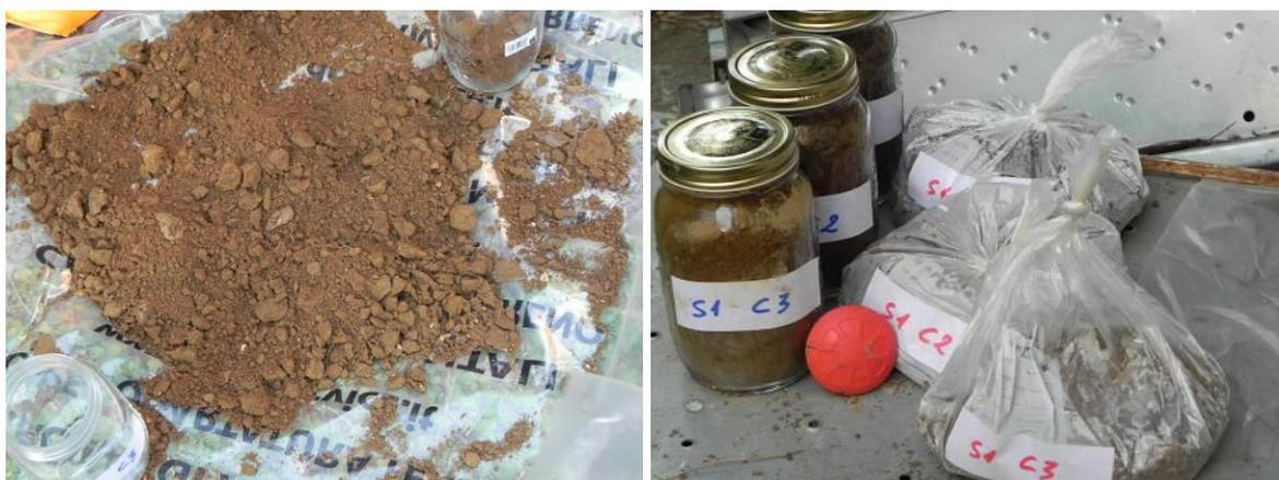
**Figura 5.1 – Deposito e miscelazione materiale scavato su telo plastico (sx) e confezionamento dei doppi campioni per le analisi di laboratorio (dx)**
