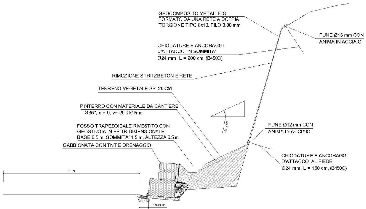
**Figura 14 – Interventi di ripristino - Sezione tipo A**
