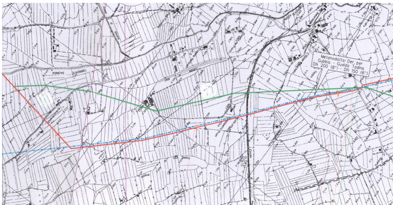
Fig. 1.4/C: Stralcio planimetrico della ottimizzazione di tracciato in prossimità dell'abitato di Mocaiana, in Comune di Gubbio (in verde il tracciato originario)
