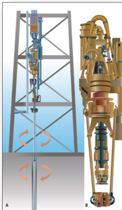
Figura 3-17 - A-Top Drive System; B-Particolare della testa motrice
