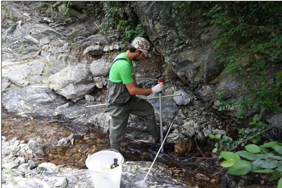
Foto 4. 2 – Misura delle portate sul Rio Trasta nella stazione T-GE-530 (Maggio 2015)
