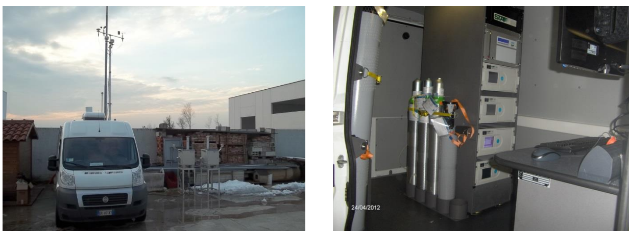
Figure 3.1 - Allestimento Laboratorio Mobile – Analizzatori e Campionatori Sequenziali
