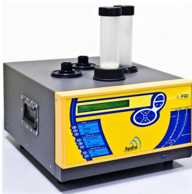
Figura 4.2.1- Hydra Dual Sampler utilizzato per il monitoraggio delle polveri
