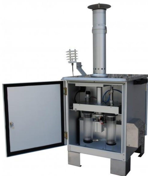
Figure 4.1.1 - Skypost Hv utilizzato per il monitoraggio delle PM10
