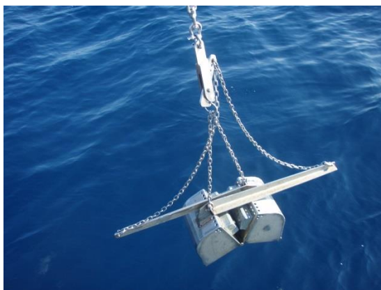
Fig. 2.6 – Benna Van Veen utilizzata per le indagini sulla comunità bentonica.
