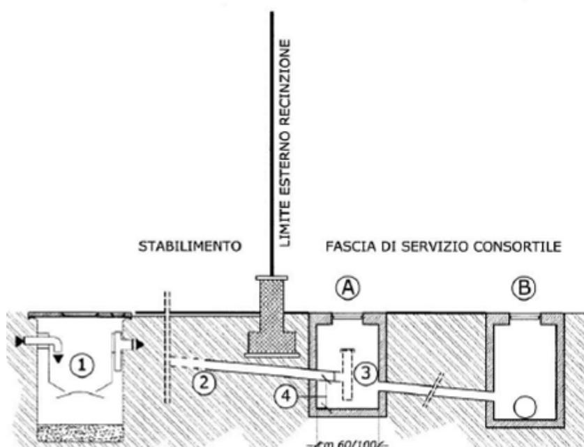
**Figura 11-5: Schema pozzetto a bordo lotto – acque nere**
