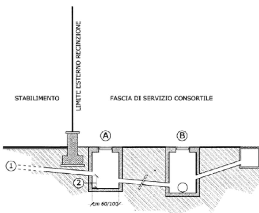
**Figura 11-6: Schema pozzetto a bordo lotto – acque bianche**
