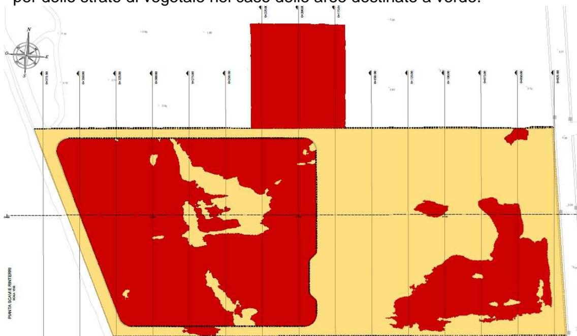
**Figura 11-2: Planimetria delle aree di scavo e riporto per la sistemazione area**
