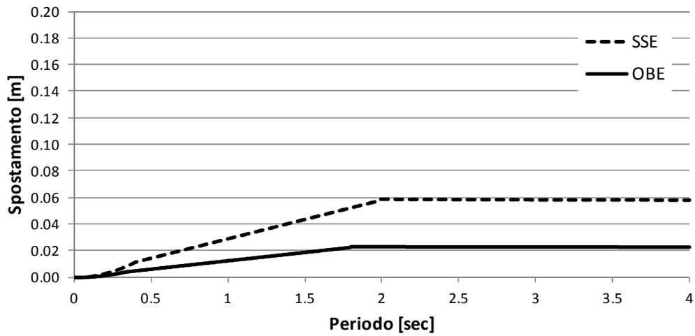
Figura 6.10: Spettro in spostamento su suolo tipo A
