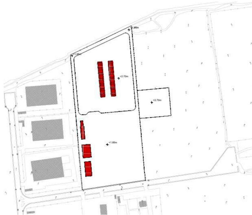
**Figura 13.2: Fase 2 preparazione piano di fondazione edifici ed esecuzione pali serbatoi**
