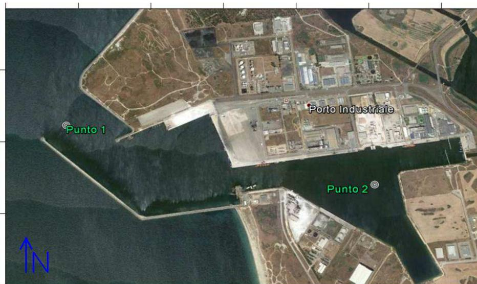
**Figura 6-4: Punti di Calcolo delle Onde Estreme Locali**
