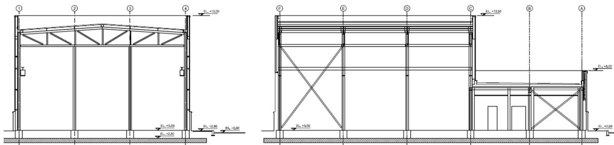
**Figura 11-13: Edificio Officina e Magazzino Sezione Longitudinale e Trasversale**
