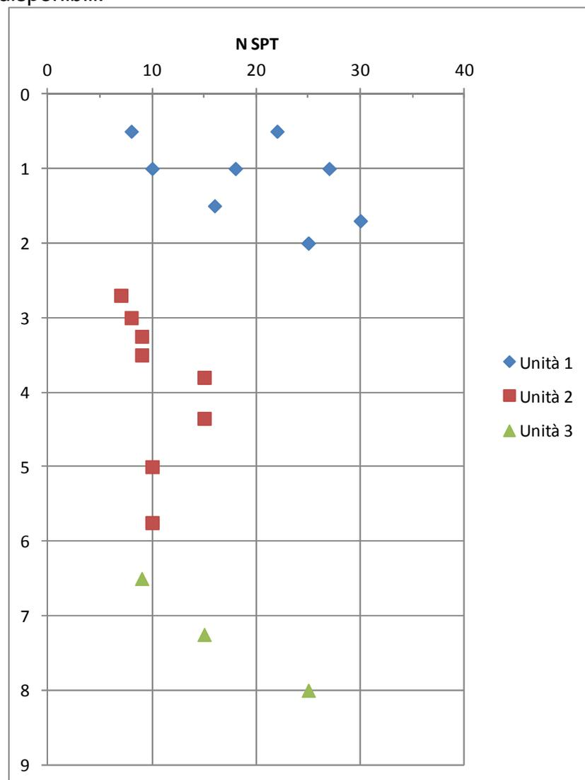
**Figura 6.5: Risultati prove SPT per unità geotecnica**
