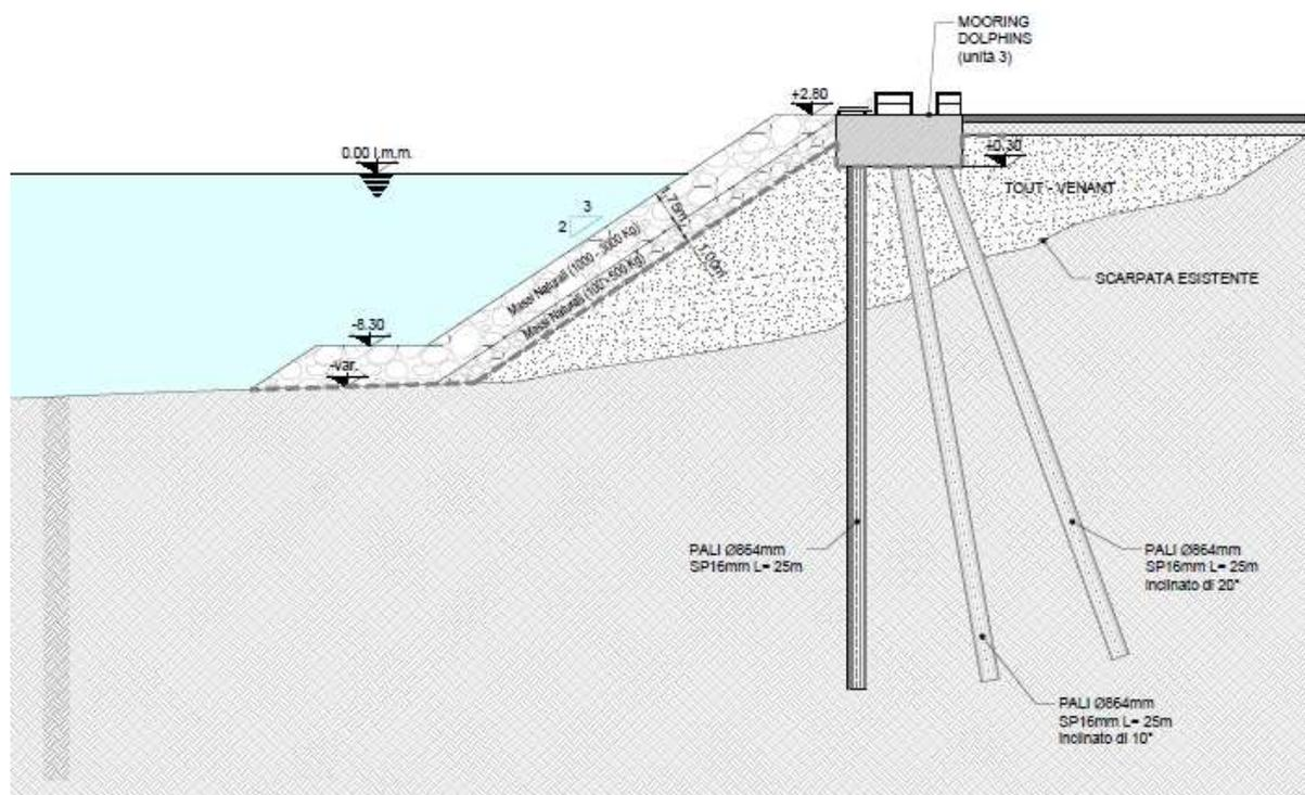
**Figura 12-4: Opera a Mare sezione tipo briccole di ormeggio**
