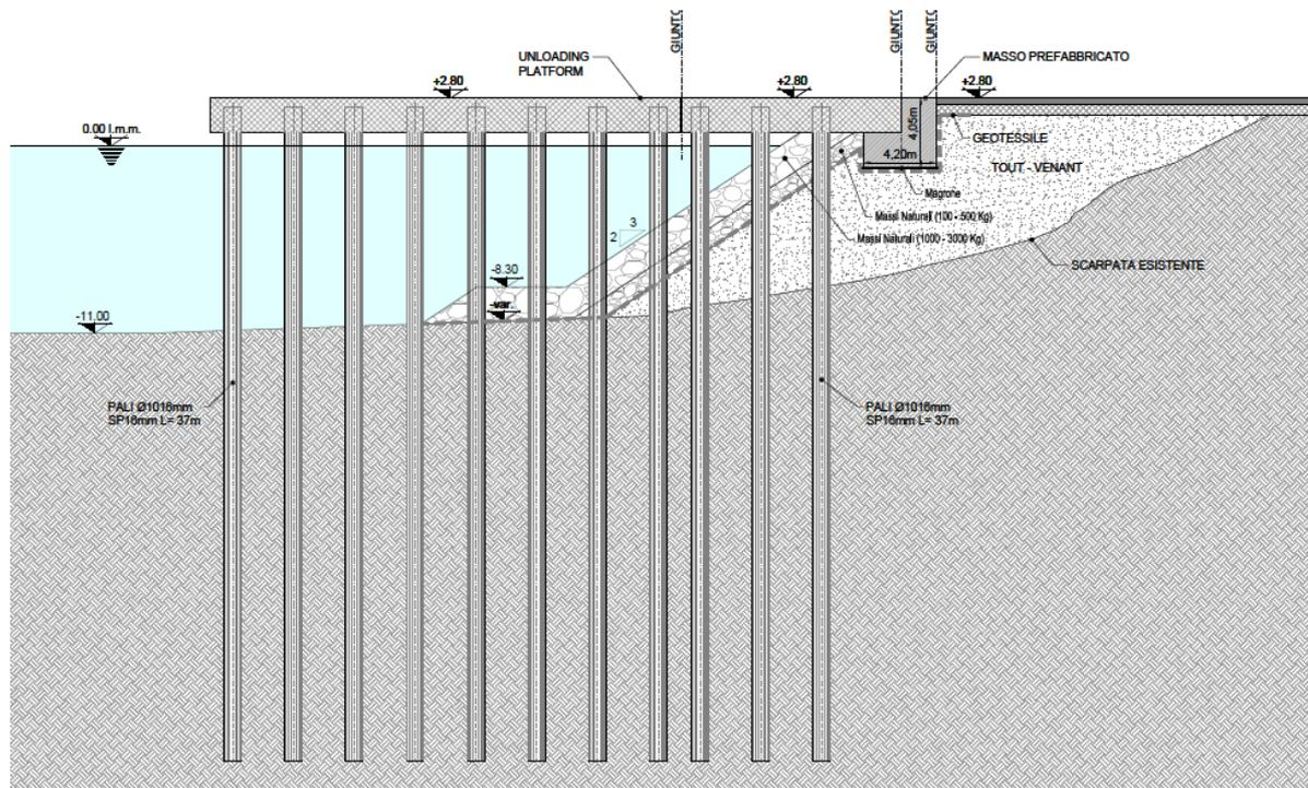
**Figura 12-3: Opera a Mare sezione tipo piattaforma di carico**
