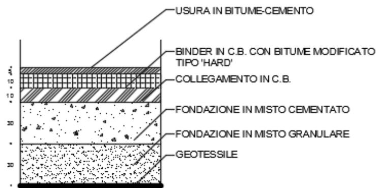
**Figura 11-4: Pacchetto di pavimentazione aree di passaggio / sosta automezzi**
