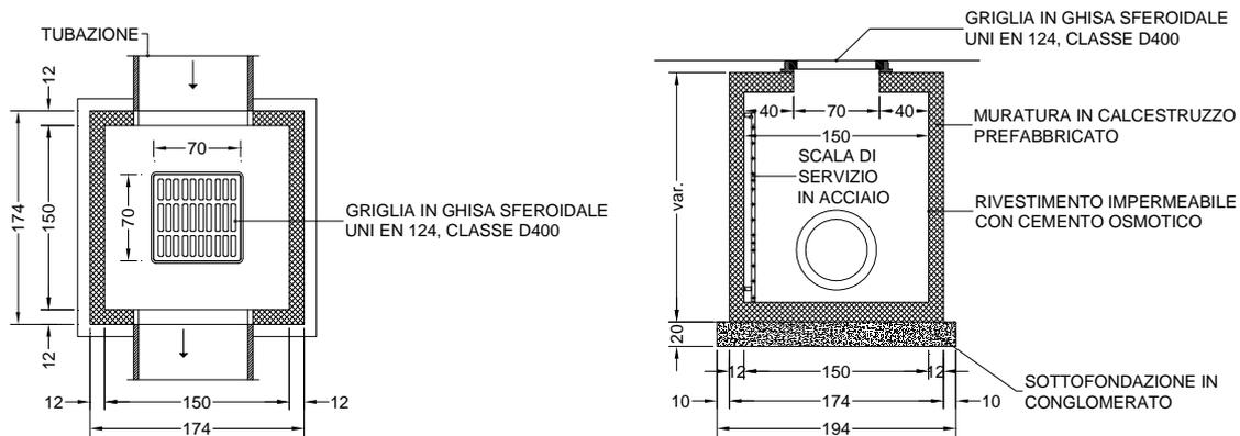
**Figura 11-8: Dettaglio Tipologico Pozzetto**
