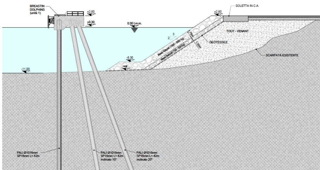
Figura 12-2: Opera a Mare sezione tipo briccole di accosto
