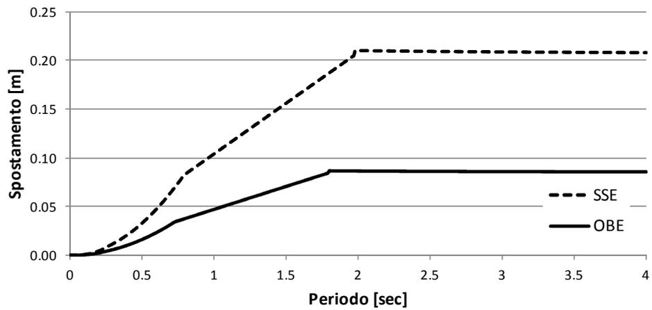
Figura 6.11: Spettro in spostamento su suolo tipo D
