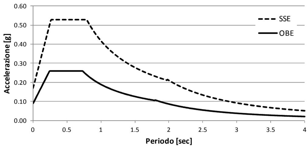
Figura 6.9: Spettro in Pseudo-accelerazione su suolo tipo D
