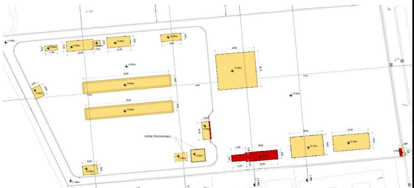
**Figura 11-3: Planimetria delle aree di scavo e riporto per le fondazioni dei singoli edifici**
