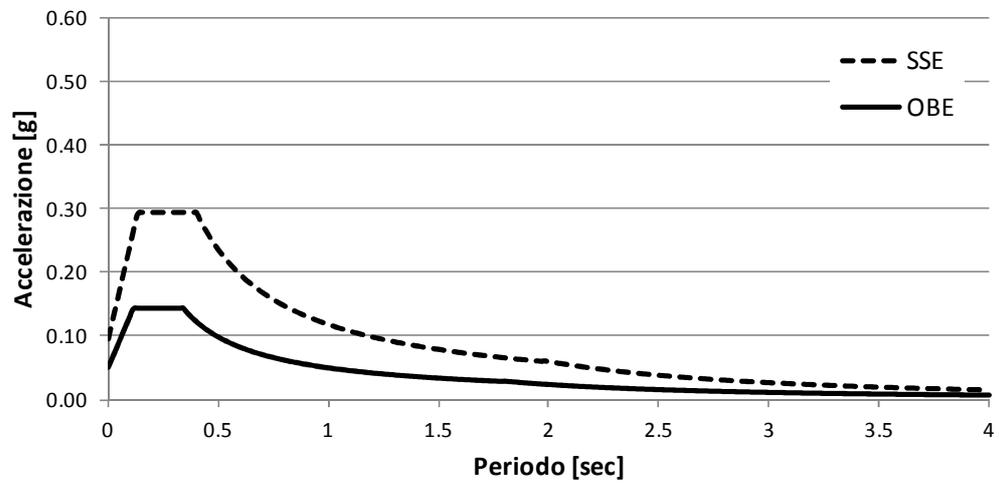
Figura 6.8: Spettro in Pseudo-accelerazione su suolo tipo A
