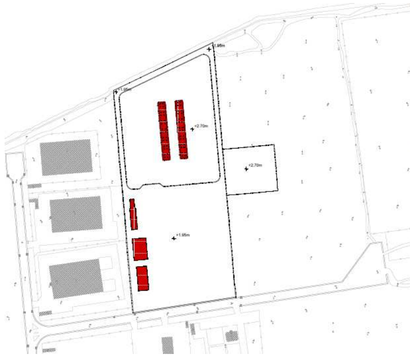
Figura 2.2: Fase 2 preparazione piano di fondazione edifici ed esecuzione pali serbatoi
