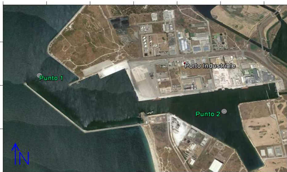
Figura 6.9: Punti di Calcolo delle Onde Estreme Locali
