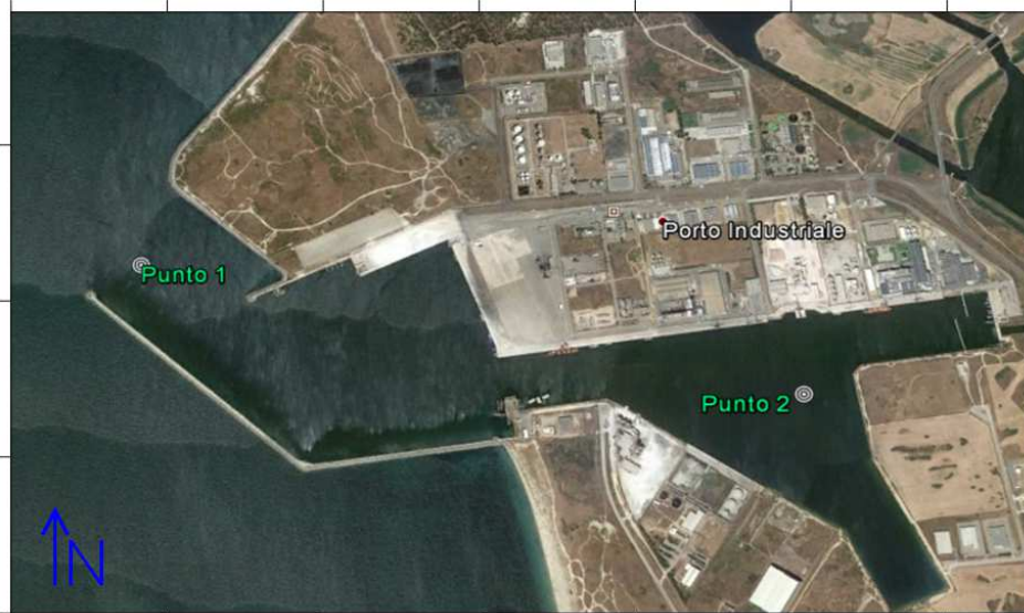
Figura 2.3: Punti di Calcolo delle Onde Estreme Locali
