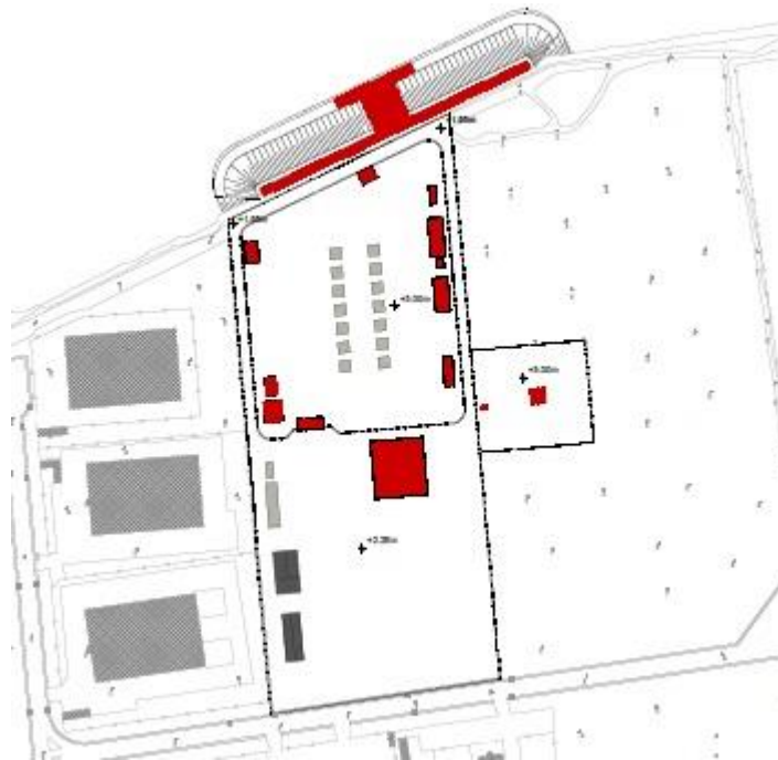
Figura 3.23: Fase 4: Completamento della Sovrastruttura della Banchina e delle Fondazioni delle Strutture dei Prefabbricati
