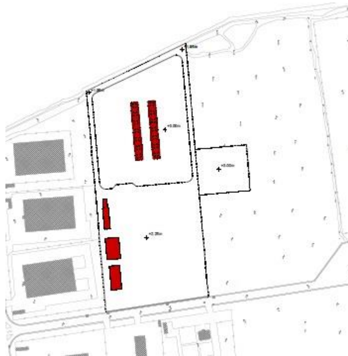
Figura 3.21: Fase 2: Preparazione del Piano di Fondazione degli Edifici ed Esecuzione dei Pali di Fondazione dei Serbatoi
