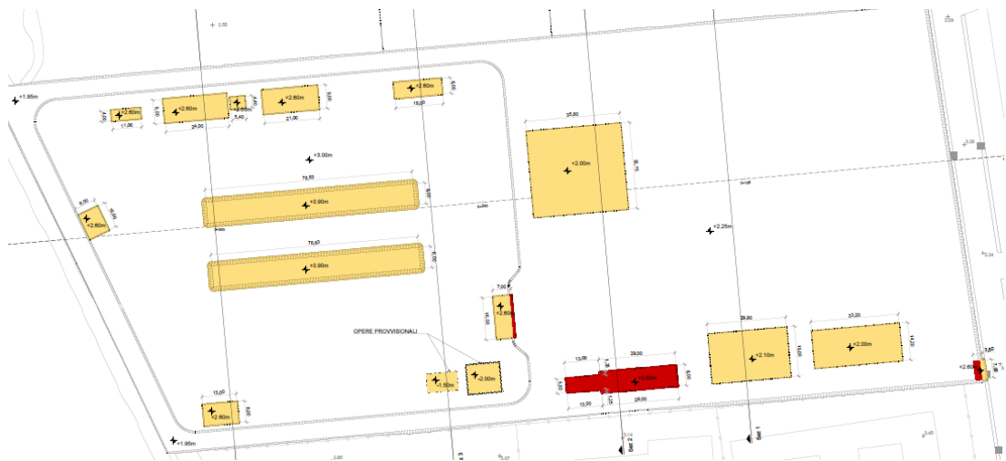
Figura 3.10: Planimetria delle Aree di Scavo e Riporto per le Fondazioni degli Edifici
